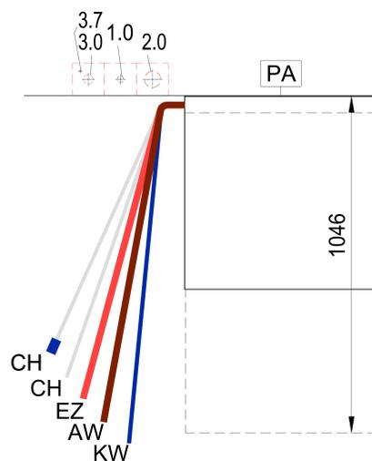
**Anschlüsse:** Der Anschluss der Spülmaschine an die Ver- und Entsorgungsleitungen (z.B. Elektro, Sanitär, Abluft) erfolgt bauseits durch örtlich konzessionierte Firmen und Fachkräfte.
